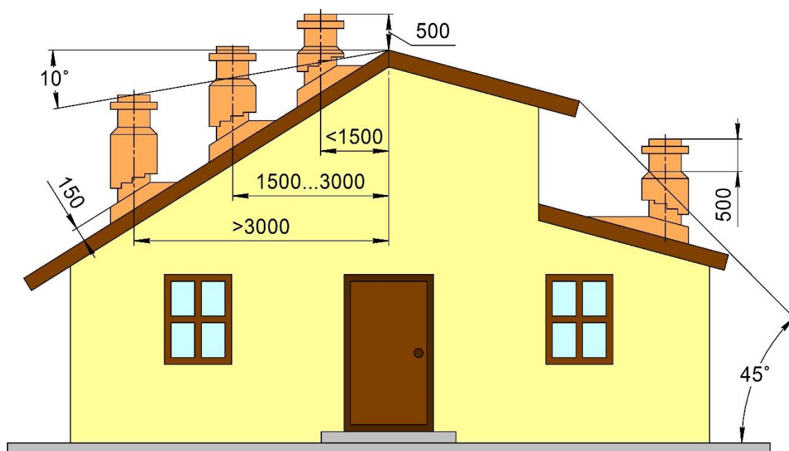
Fig. 6. Schema selectării corecte a înălțimii coșului de fum deasupra acoperișului
